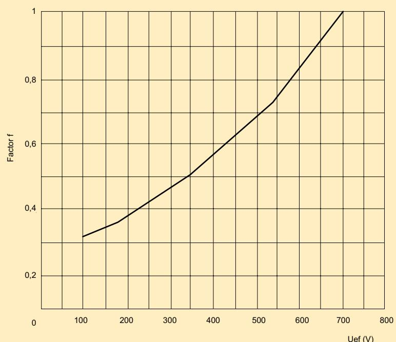
**Maximal auftretende Schaltspannung / Maximum arc voltage occurring**
