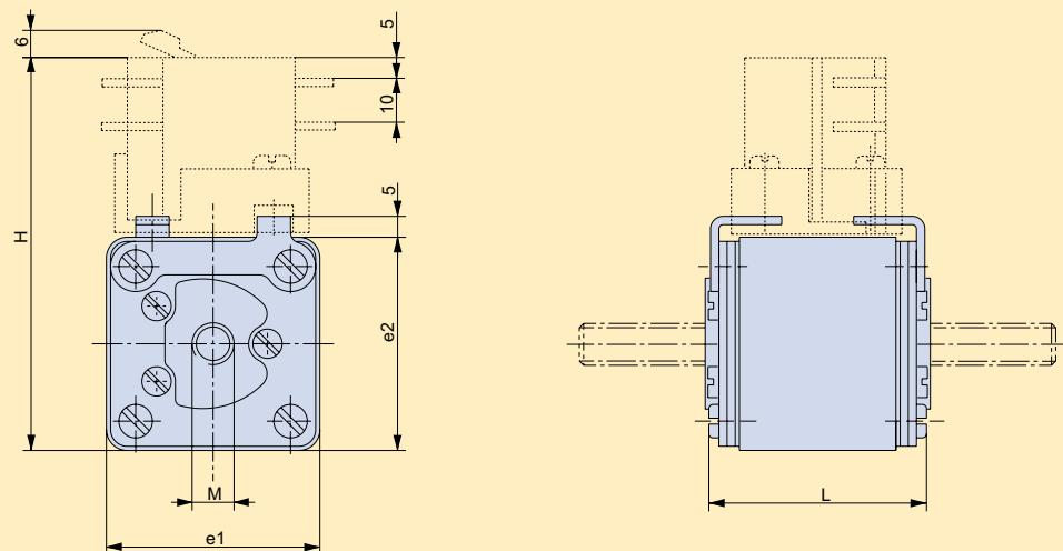
\* Mit Adapter AMK und Mikroschalter MK / With adapter AMK and microswitch MK
