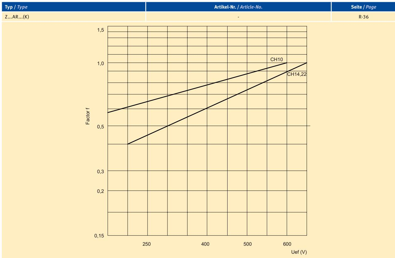
**Maximal auftretende Schaltspannung / Maximum arc voltage occurring**
