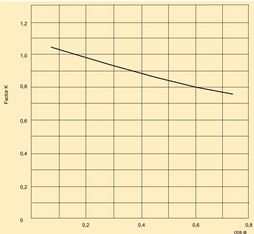
**Kennlinien gR AC500V-690V / Characteristics gR AC500V-690V****Umrechnung Leistungsabgabe bei Teillast / Conversion power dissipation for partial load**
