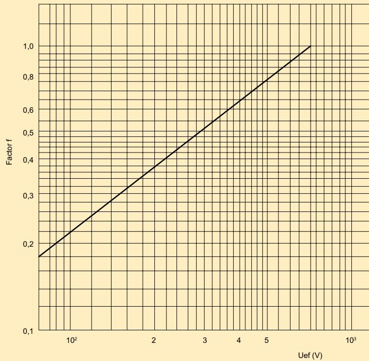
**Maximal auftretende Schaltspannung / Maximum arc voltage occurring**
