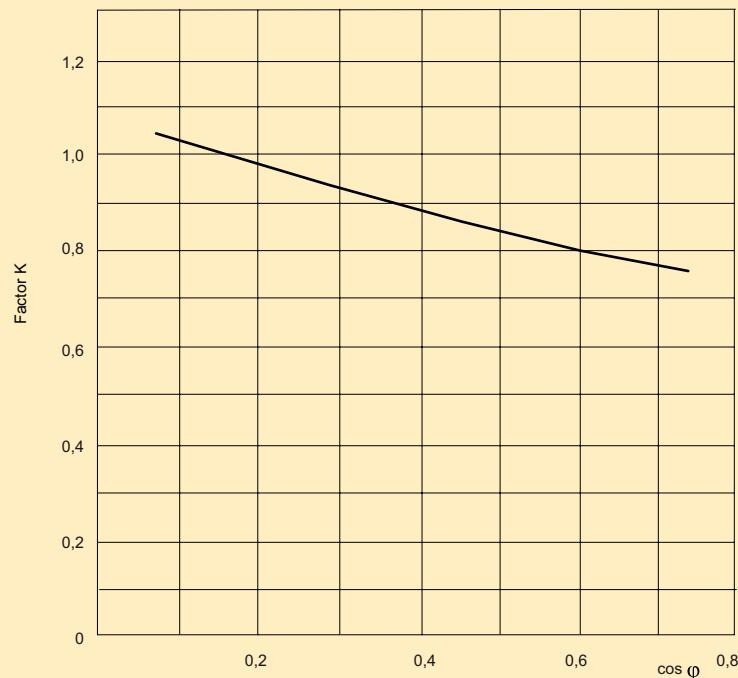
**Umrechnung Leistungsabgabe bei Teillast / Conversion power dissipation for partial load**
