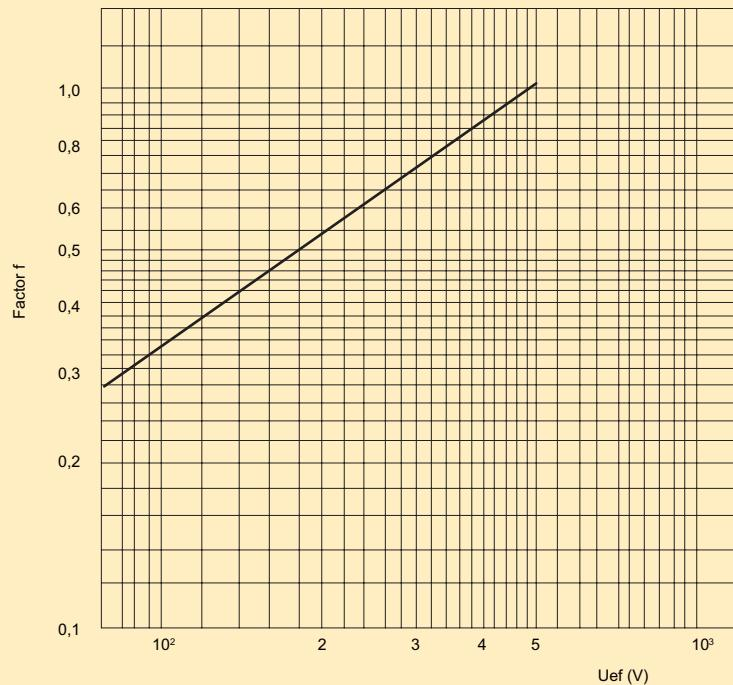
**Kennlinien gR AC500V-690V / Characteristics gR AC500V-690V****Umrechnungsfaktor Ausschaltintegral / Conversion factor Operating  $I^2t$**
