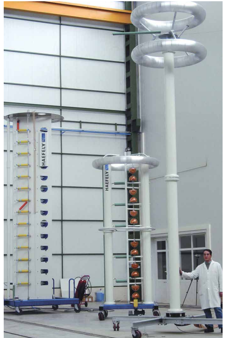
Syöksyjännitekokeen suorittamiseen tarkoitettu testausala
